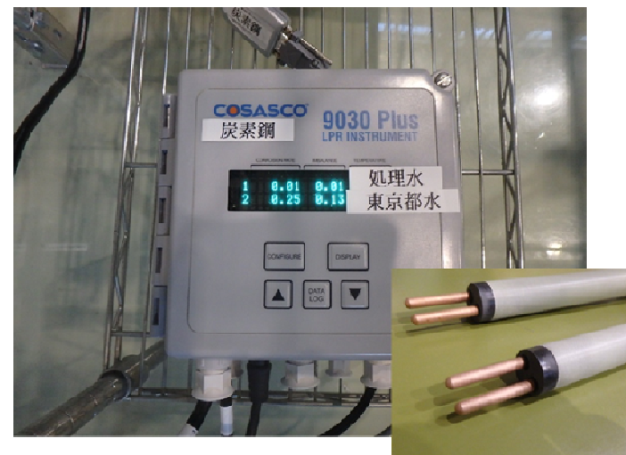
写真 腐食センサー
