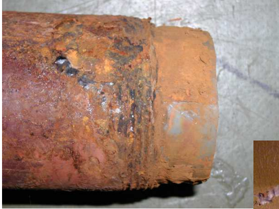
給湯銅管の潰食 (7年で漏水)
