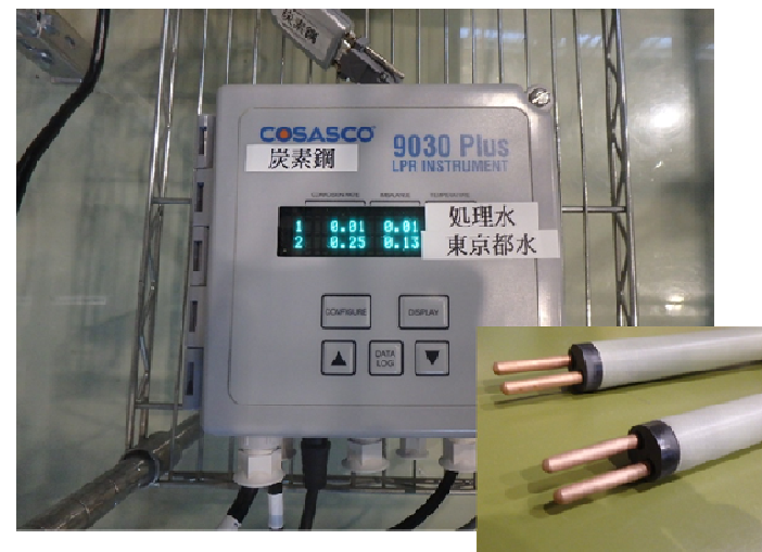
写真 腐食センサー
