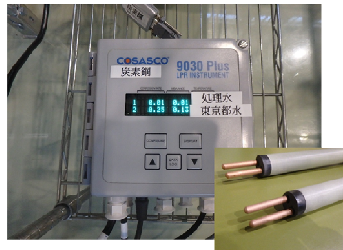
写真 腐食センサー
